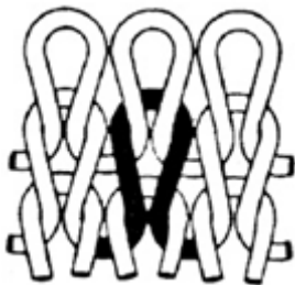
Columnas y cursas en ángulo recto (no hay revirado)
